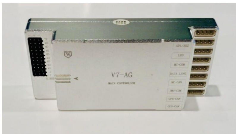
含有课题成果算法方案的无人机主控单元
